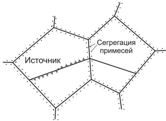
Рис. 5 – Схема торможения дислокаций у границы зерен при взаимодействии с сегрегацией примесей
