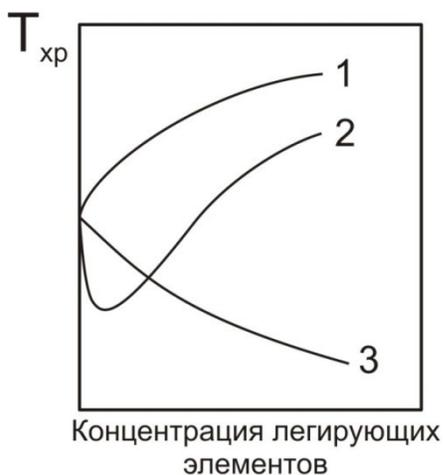
Рис. 7 – Схемы изменения температуры  $T_{хр}$  тугоплавких металлов при легировании
